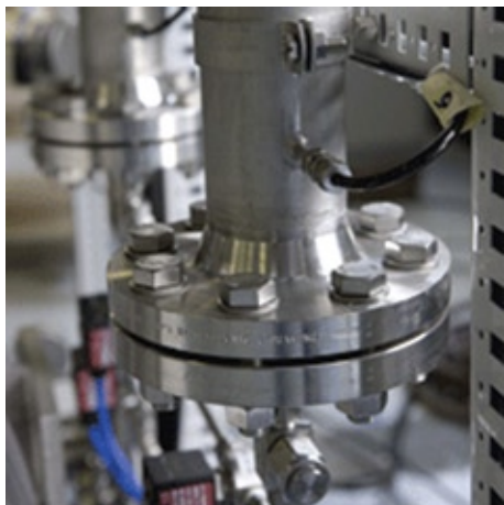
Figur 11 Elektrolysör från Morphics dotterbolag AccaGen. Vätgas med upp till 200 bar kan genereras utan kompressorer.
