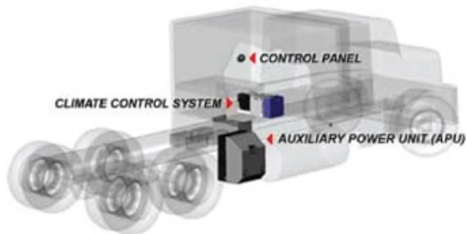
Figure 36: En konceptbild på en monterad APU på lastbil.
