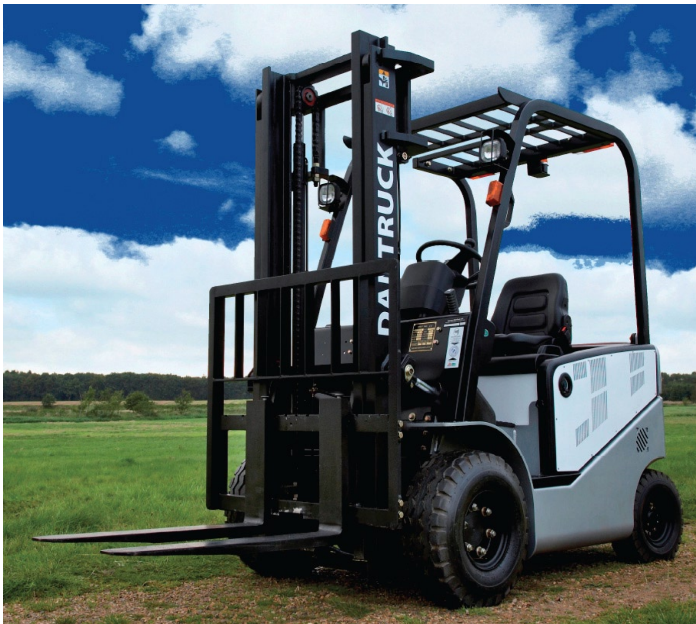
Figur 7 Gaffeltruck med bränslecell från Powercell.
