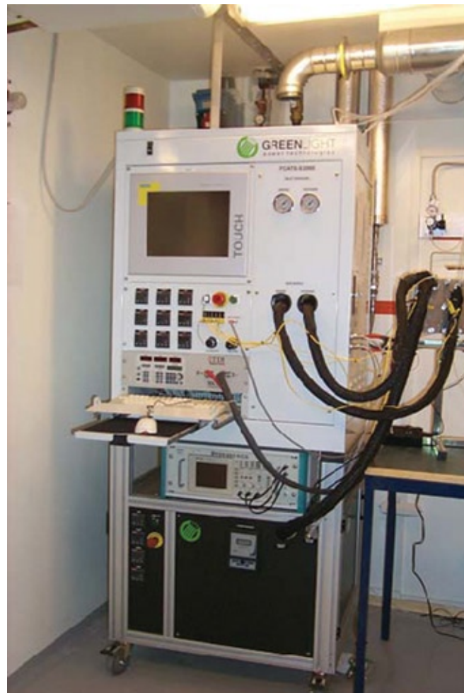
Figur 29. Teststation för enskilda celler eller småstackar.
