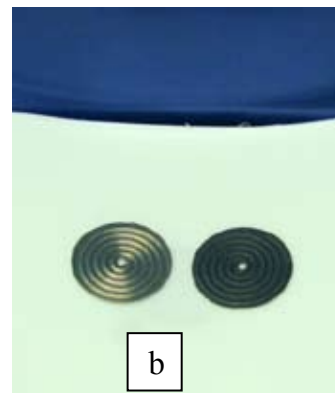
b) Två stycken rostfria stål från Outokumpu som fungerar som bipolära plattor; en belagd platta med en ytbeläggning från TIMCAL och en utan beläggning. Båda plattorna är formade av Cell Impact (Morphic).
