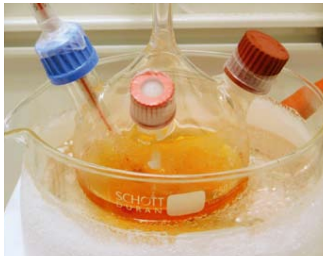
Figur 3. Kemisk syntes av polysulfon med sulfonerade sidokedjor pågår.
