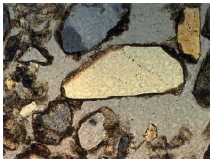
Figur 2. Mikroskopbild av partiklar i rostjorden. Partiklarna är cirka 0,1 mm i diameter och de är belagda med utfällningar från DOC tillsammans med järn- och aluminiumhydroxider.
